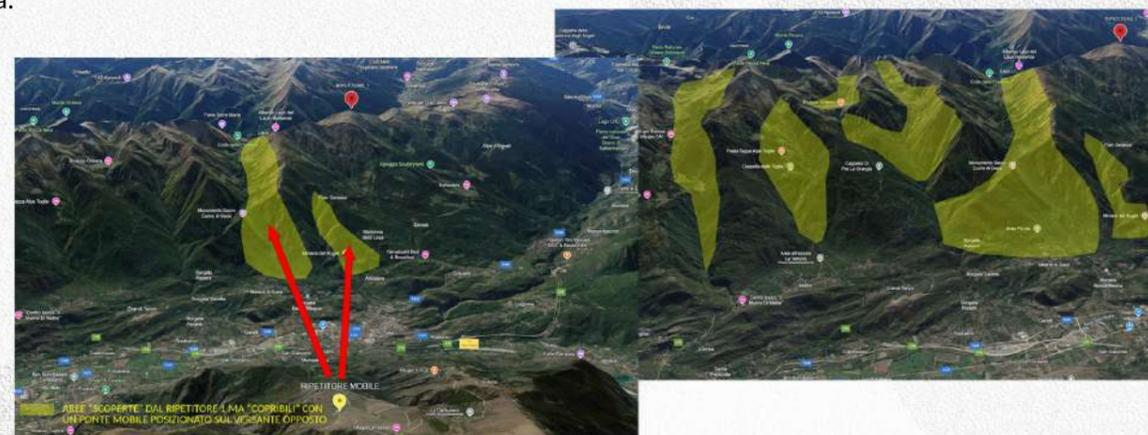
Funzionamento di un "Ponte Radio Mobile" (segnalino giallo), in grado di sopprimere ai limiti di copertura di un "Ponte Radio Fisso" (segnalino rosso). Le superfici gialle sarebbero quelle "non coperte" dal "Ponte Radio Fisso".
